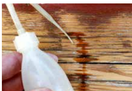
Benetzungsprobe, um zu prüfen, wie saugstark das Holz ist
