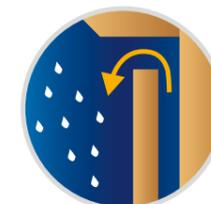
Hinterlüftung von Fassaden verhindert einen Feuchtestau, hierbei ist es wichtig, dass vor der Montage der Fassadenverkleidung auch die Rückseite grundiert wird.
