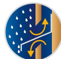
Stoßverbindungen eignen sich, um längere Fassadenprofile im Hirnholzbereich zu schützen. Diese sind so anzulegen, dass anfallendes Wasser abgeleitet wird und abtropfen kann.
