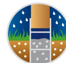
Den Kontakt mit Pfosten und Balken direkt zum Erdreich vermeiden! Hierbei hilft die Verwendung von Ständerfüßen. Bohrlöcher sollten nur an den vom Wetter abgewandten Seiten angebracht werden.
